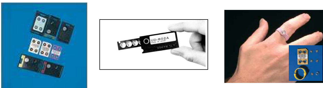
Figura14: Ejemplos de dosímetros personales TL, incluyendo a la derecha un dosímetro de anillo diseñado para la medida de dosis localizada en los dedos.
