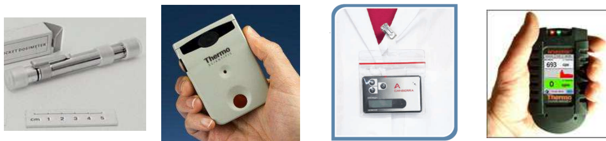
Figura 16: Dosímetros activos de lectura directa. De izquierda a derecha: Dosímetro de pluma basado en detector de cuarzo. Dosímetro Thermo y Dosicard basados en detectores de diodo de Si. Dosímetro Interceptor con capacidad espectrométrica basado en varios detectores de centelleo.
