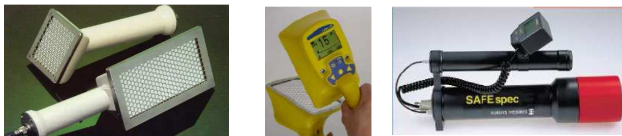
Figura 8: Monitores de contaminación superficial basados en detectores de centelleo. Izquierda: Detector de \text{ZnS}(\text{Ag}) . Centro: Plástico de centelleo. Derecha: Detector de \text{NaI}(\text{TI}) .
