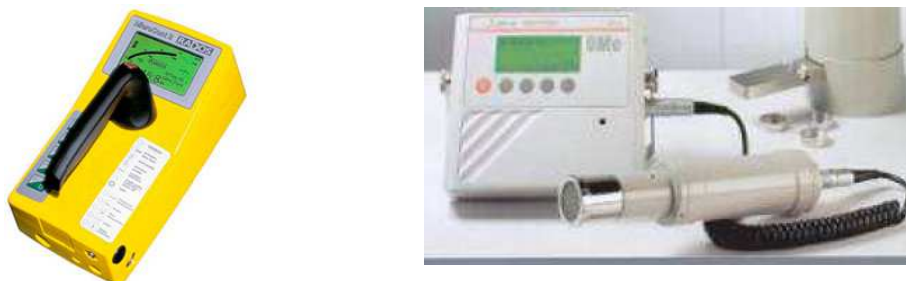
Figura 6: Monitores de contaminación superficial basados en detectores de ionización en gases. Izquierda: Contador proporcional. Derecha: Tubo Geiger-Müller.
