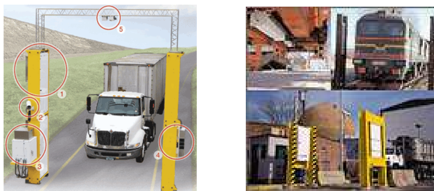
Figura 9: Aplicación de monitores de área basados en detectores de centelleo a controles de acceso de vehículos y procesos industriales.
