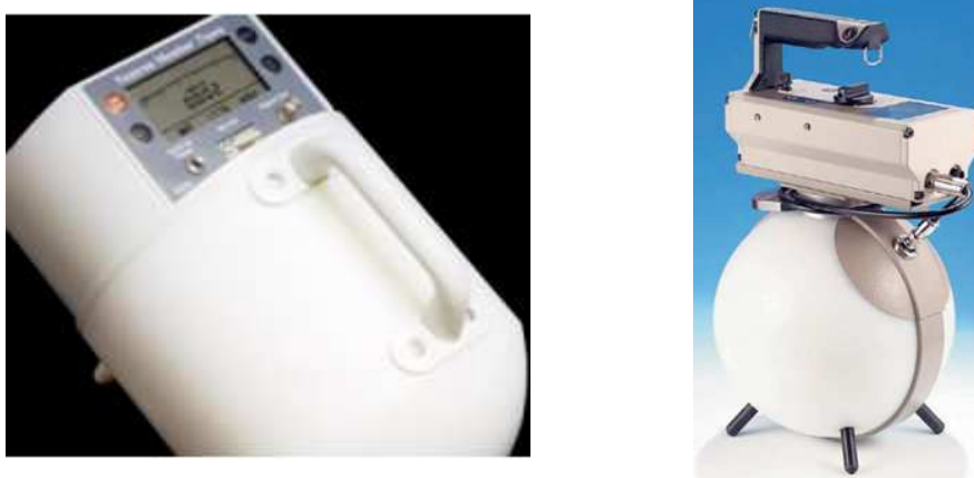
Figura 17: Monitores de área para neutrones. Izquierda: Moderador cilíndrico (tipo Anderson-Braun) y detector de centelleo de \text{BF}_3 . Derecha: Moderador esférico (tipo Leake) con lámina de Cd y contador proporcional de ^3\text{He} .
