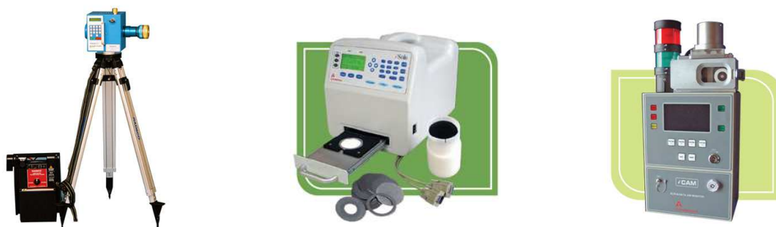
Figura10: Medios para la vigilancia de la actividad en el aire. Izquierda: Muestreador de aire de alto flujo con caudalímetro y totalizador de volumen. Centro: Ejemplos de soportes y filtros y equipo para su medida tras el muestreo de aire. Derecha: Monitor de aire en continuo basado en detector de semiconductor con filtro continuo.
