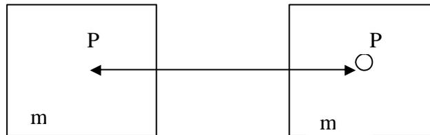
Debido a que la dosis en una magnitud puntual, la fluencia de electrones debe ser uniforme en la cavidad para que el principio sea válido. Además, la teoría como tal asume que la cavidad (cámara de ionización) no perturba ni la fluencia de electrones ni de fotones primarios y que la interacción de esos fotones con el gas es despreciable, por lo que la dosis absorbida en la cámara es debida a los electrones liberados fuera de la cavidad.
