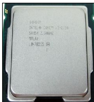
Figura 12. Microprocesador Intel® i3 2120, 3.30 GHz
