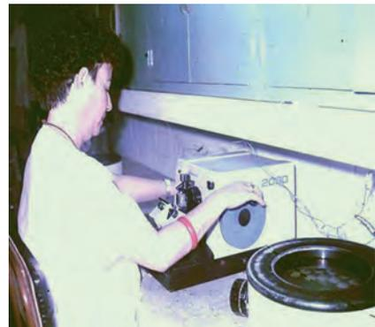
**Fig. 2.16.** Corte en micrótopo vertical.
