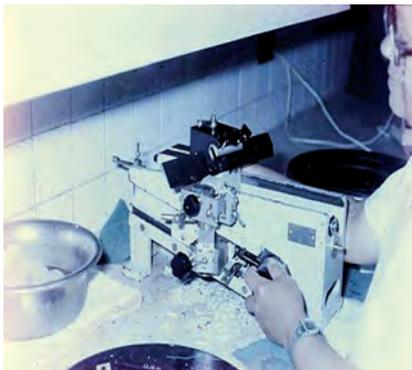
**Fig. 2.15.** Corte en micrótopo horizontal.
