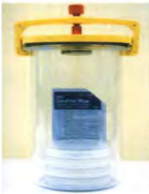
Jarra para el cultivo de anaerobios
