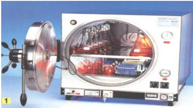
Autoclave. Se observa la disposición del material a esterilizar.
