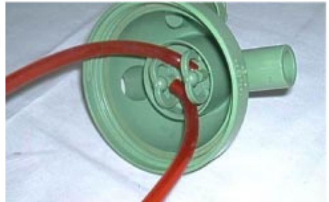
Fig. 51.4. Humedificadores del tipo jet, o bernouilli, o surtidor; con dispersor, o anvil.
