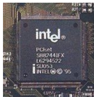
FIGURA 2.9. CHIPSET INTEL DE UNA PLACA BASE
