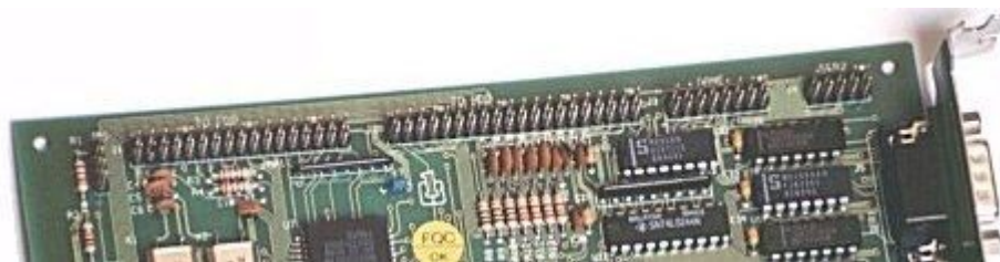
FIGURA 2.13 PLACA BASE INTERNA CON CONECTORES PARA DISCOS DUROS, DISQUETERA, ETC.
