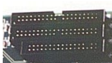
FIGURA 2.12 CONECTORES IDE PARA DISCO DURO, CD-ROM Y DISQUETERA
