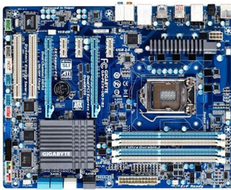
La placa madre, también conocida como motherboard o placa base, es un circuito impreso con gran cantidad de componentes electrónicos en su superficie (resistencias, circuitos integrados, transistores, etc.). Además, incluye diferentes tipos de sockets o conectores para agregar más hardware a la computadora.
