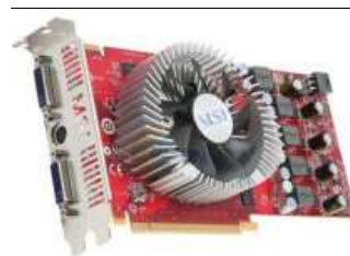
Figura 1. Tarjeta aceleradora de gráficos, marca MSI®, con GPU ATI®, modelo HD4830, GDDR 512 Mb, interfaz PCI-E 2.0 16X, DVI/S-Video
