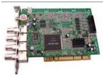
Figura 2. Tarjeta capturadora de video, marca Averdigi®, modelo NV3000, conector BNC 4 canales
