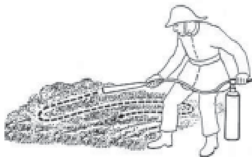
Figura 9.10. Extintor de dióxido de carbono. Aplicar en forma de barrido sobre la superficie del material inflamable.
